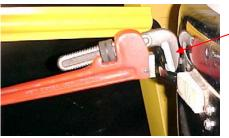
2.) WITH ARM IN OPEN POSITION - PLACE A SUITABLE WEDGE IN-BETWEEN THE ARM & THE EDGE OF THE BUMPER HOLE AS SHOWN ABOVE.
